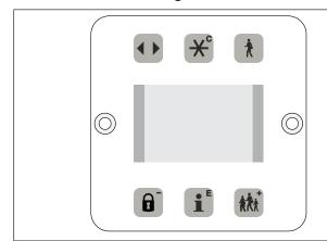
Die Bedienungseinheit BDE-D ist eine Ein- und Ausgabeeinheit für die Bedienung und eingeschränkte Programmierung der Anlage. Das Display zeigt Informationen zur Anlage mittels Symbolen und Text an.
