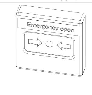
Bei einem Systemausfall oder im Panik Fall reicht die Betätigung des Fluchtweg-Notschalters, um die Anlage in Sicherheitsstellung zu bringen.
